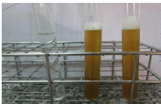
Hình 9. Thử nghiệm tính tạo bọt định tính saponin
